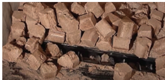
Рис. 4.4. Шнекова система подачі брикетів в котел
