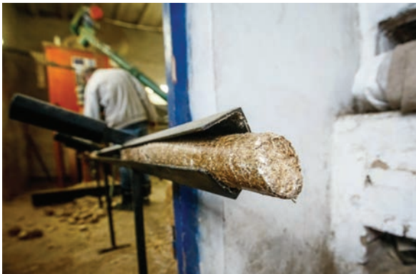
а) Лінія з виробництва брикетів з соломи в с. Кінські Роздори Запорізької області 16
