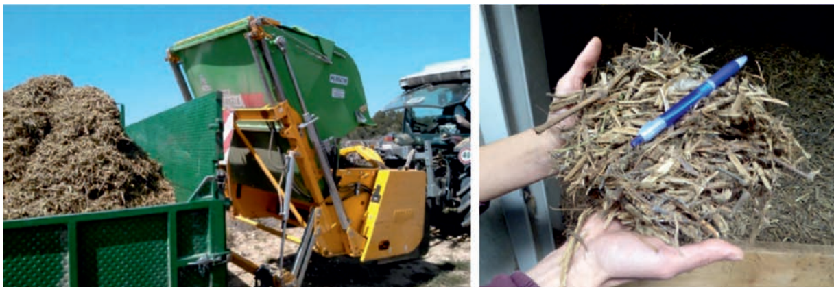
Рис. 5.6. Крупна тріска з обрізок виноградної лози, що використовується як паливо в котлі 500 кВт м. Вілафранка-дель-Пенедес (Іспанія)
