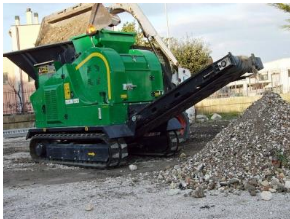
Мал. 24 Мобільний подрібнювач бетону (в умовах обмеженого простору)
