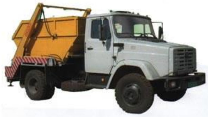
Мал. 20. Сміттєвоз порталний спеціалізований СВГ-003 з кузовом-контейнером
