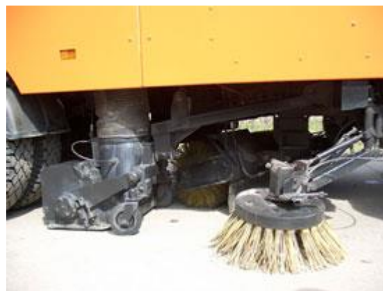
Мал.33. Машина підмітальна вакуумна КО-326 на шасі МАЗ-5337 (євро 3)
