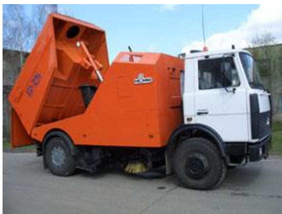
Мал.33. Машина підмітальна вакуумна КО-326 на шасі МАЗ-5337 (євро 3)
