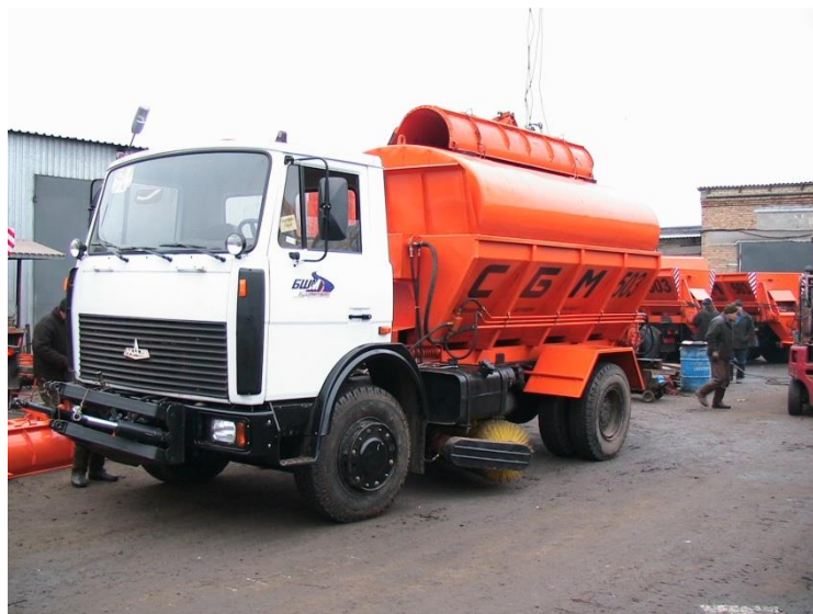
Мал.32. Машина дорожня комбінована зі змінним обладнанням МДКЗ-10 на базі автомобіля МАЗ-5340
