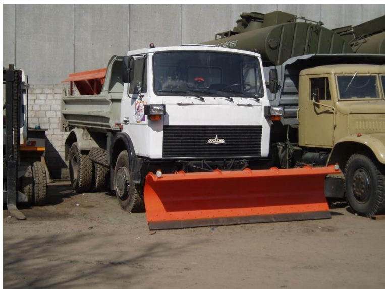
Мал. 30. Машина дорожня комбінована зі змінним устаткуванням МДКЗ-3 на базі самоскида МАЗ-5551
